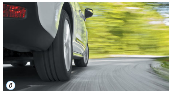
Рис. 8.9. Сила тертя є рушійною як для людини ( a ), так і для автомобіля ( б )
