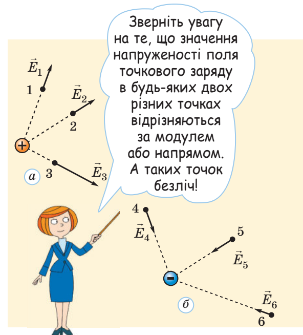
Рис. 30.2. Напруженість електричного поля позитивного точкового заряду в точках 1, 2, 3 напрямлена від цього заряду, а напруженість поля негативного точкового заряду в точках 4, 5, 6 напрямлена до цього заряду. В обох випадках модуль напруженості тим менший, чим далі точка від заряду
