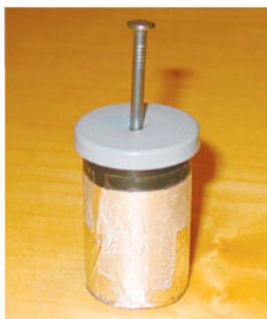
Рис. 33.2. Саморобний конденсатор (модель лейденської банки)
