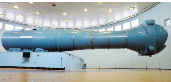
Рис. 12.4. Центрифуга для підготовки космонавтів
