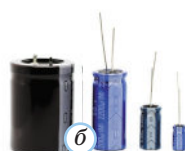
Рис. 33.3. Різні типи конденсаторів: a — полімерні; b — електролітичні; v — керамічні; z — паперовий
