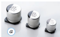
Рис. 33.3. Різні типи конденсаторів: a — полімерні; b — електролітичні; v — керамічні; z — паперовий
