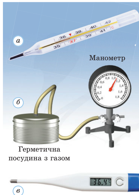
Рис. 22.2. Термометри: a — рідинний; b — газовий; в — електронний
