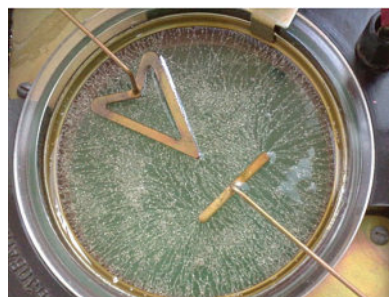
Рис. 31.5. Силові лінії електростатичного поля поблизу провідників
