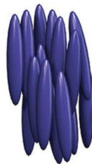
Рис. 25.3. Структура нематичного рідкого кристала
