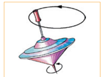
Рис. 1.4. Явище прецесії демонструє дитяча дзига, що обертається навколо власної осі, у той час як її вісь описує конус у просторі
